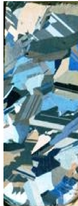
Рис. 6. Макроструктура полікристалічного кремнію до зонної перекристалізації X5.
