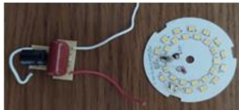
Рис. 7. Лампочка з 28 світлодіодів та електронний драйвер на обмежуючому конденсаторі (зліва).
