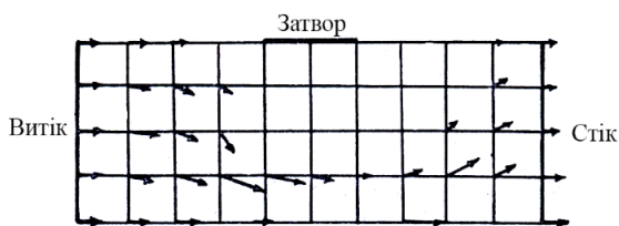
Рис. 4. Розподілення струму в каналі ПТ.
