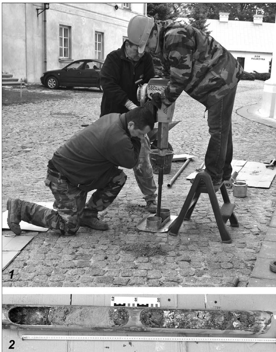
Рис. 15. Розвідкове архео-геологічне буріння на Катедральній горі в Холмі 2013 року: 1 – робочий процес; 2 – відображення стратиграфії в пустотному свердлі
